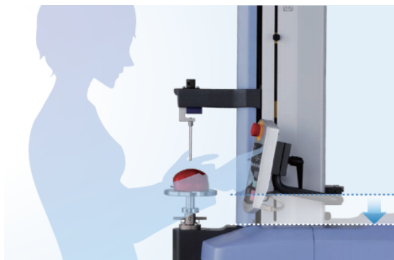
Imagen 5. Medición de la resistencia al descementado.
